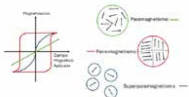
Figura 1. Representación de diferentes propiedades magnéticas. En verde el lazo de histéresis típico de un material paramagnético; en este caso sus espines se encuentran completamente desorientados en ausencia de un campo magnético. En rojo, el ciclo de histéresis de un material ferromagnético. En estos materiales se observa la presencia de dominios. Por último, en azul, se observa el comportamiento de un material superparamagnético, debido este comportamiento a la existencia de monodominios.
