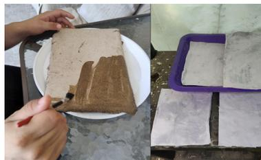
Figura 9. Impermeabilización y refuerzo del lirio por el primer método. Elaboración Propia
