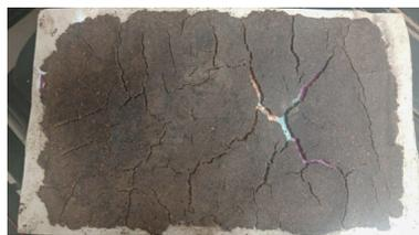
Figura 8. Placa de Lirio secada al Sol que presenta una fractura muy grande en su estructura.
