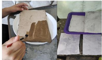
Figura 9. Impermeabilización y refuerzo del lirio por el primer método. Elaboración Propia
