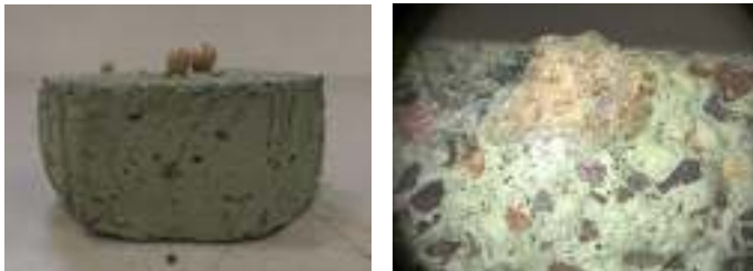
Figura 4. Presencia de burbujas en el adoquín después de 4 días de prueba en cámara de cambios climáticos.
