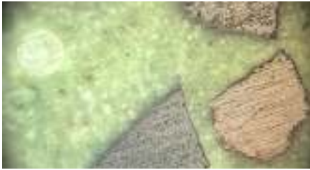
Figura 7. Microestructura de la matriz polímero/solvente-cemento en un aumento x20
