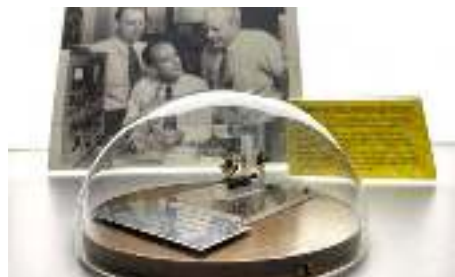
Figura 1. Réplica del transistor de punto de contacto original de los Laboratorios Bell. https://spectrum.ieee.org/point-contact-transistor
