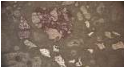
Figura 6. Microestructura de la matriz polímero/sovente-cemento en un aumento x5 Nota. Elaboración propia
