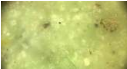
Figura 8. Microestructura de la matriz polímero/solvente-cemento en un aumento x50
