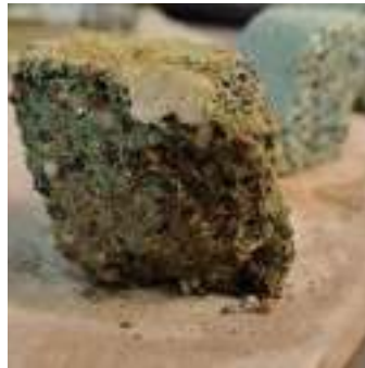
Figura 11. Muestra deteriorada por HCl
