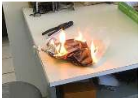
Figura 4. Fotografía de una batería de ion-Li que se incendió en el laboratorio del autor, durante una práctica. Elaboración propia.
