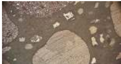
Figura 6. Microestructura de la matriz polímero/sovente-cemento en un aumento x5 Nota. Elaboración propia
