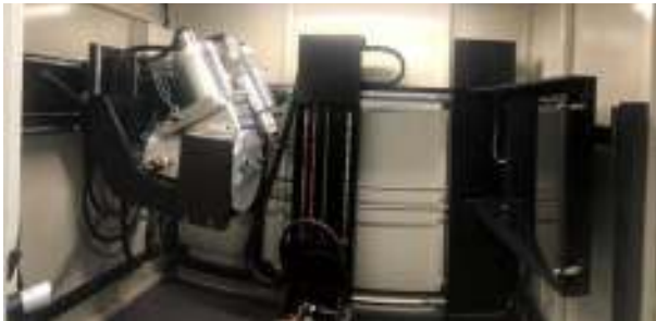
Figura 12. Tomógrafo Computarizado de fuente dual 225kV/450kV ubicado en LIMA-DITCo BUAP. (Autoría propia) Computarizada (central) e Impresión 3D (derecho). (Autoría propia)
