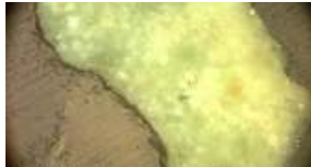
Figura 8. Microestructura de la matriz polímero/solvente-cemento en un aumento x50
