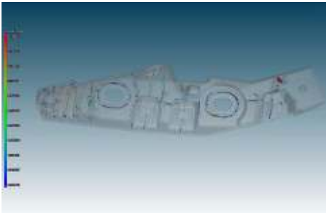
Figura 8. Imagen 3D pieza plástica con análisis de porosidad. (Autoría propia)
